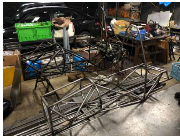
・フレーム完成
